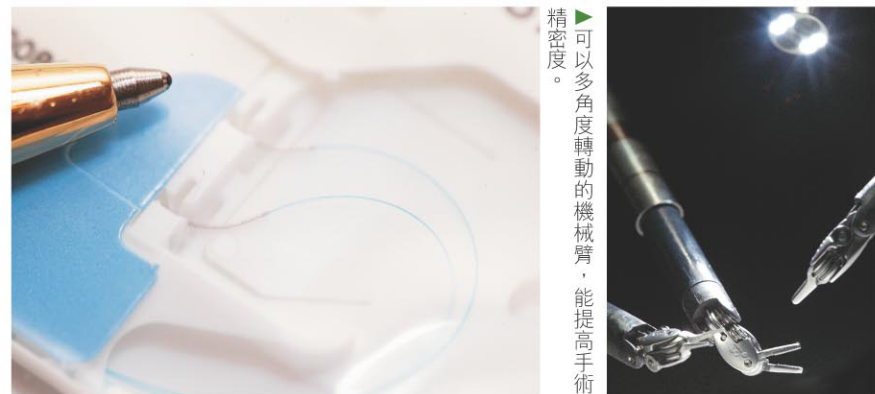
▲機械臂能過濾醫生操控時的手部震動，提高手術時的穩定度。
