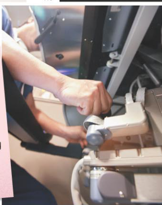
可以多角度轉動的機械臂，能提高手術精密度。
